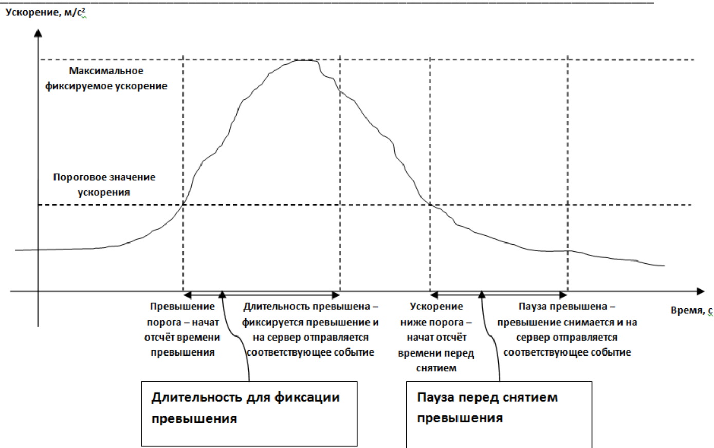
Рис. 155. Графический смысл регистрации превышения ускорений
