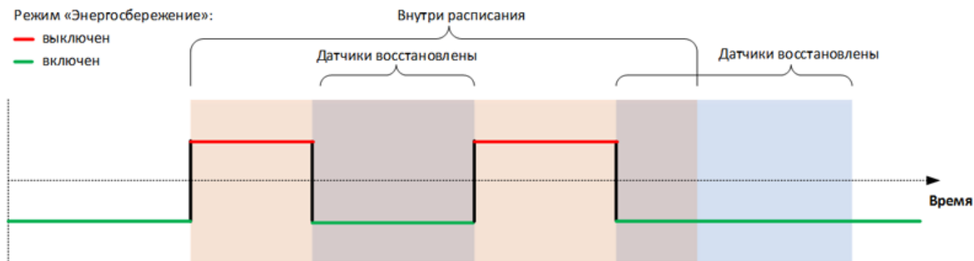
Рис. 50. Логика перехода в режим энергосбережения
